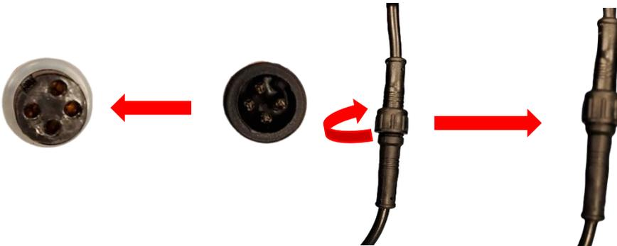
將土壤感測探針的接頭插上頂蓋兩邊的 Mini Din 端，插上後再將螺母順時針鎖緊。
